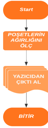
Şekil 4: Ağırlık Sensörü Akış Diyagramı
